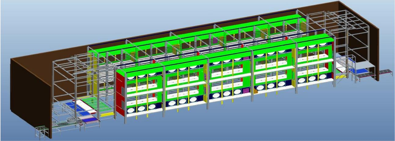
◎ El dispositivo de túnel inteligente automático (Carton Freezer) es un equipo especial diseñado para la congelación rápida de alimentos a gran escala, como productos de carne y aves a gran escala en bandejas (cajas). Es un sustituto ideal para el túnel estático tradicional actual.
